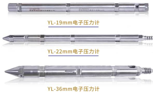
YL系列高精度存储式电子压力计可以适应各种井下高温、高压、高震动、高腐蚀等恶劣环境。广泛用于各种静压、流压等井下压力测试工作。该压力计由传感器、记录和供电三部分组成。传感器包括压力传感器及温度传感器，分别用于将井下的压力、温度转成电信号；记录包括单片机和存储器，用于对传感器产生的信号进行采样并保存；供电采用美国进口高温高能电池。
