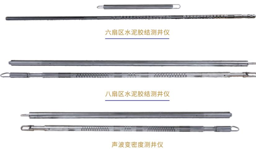
思坦六扇区和八扇区水泥胶结测井仪均为直读、存储一体化设计。由CBL信号、扇区信号、VDL信号组成。CBL反映第一胶结面的情况，扇区信号辅助CBL判断第一胶结面存在的槽道、孔洞的位置、大小及分布情况，VDL补充分析第一胶结面的情况，也能定性解释第二胶结面。
